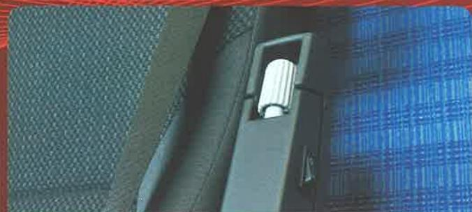
Commande du microphone intégrée dans l'accoudoir du siège du chauffeur.
