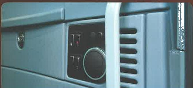
Interrupteurs astucieusement positionnés près de la porte avant. Verrouillage central et éclairage des compartiments à bagages, éclairage côté trottoir (option), éclairage de la tablette du guide.
