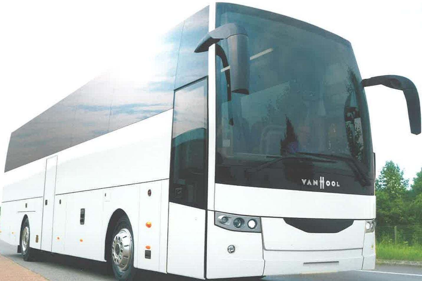
La flexibilité du concept modulaire permet de concevoir des véhicules adaptés à une large palette d'applications: de l'autocar de tourisme au full seater à 2 ou 3 essieux avec un vaste espace pour les bagages en passant par le 65+1+1 places, avec ou sans toilette, équipé d'une porte centrale large ou étroite, avec ou sans élévateur pour les fauteuils roulants.
