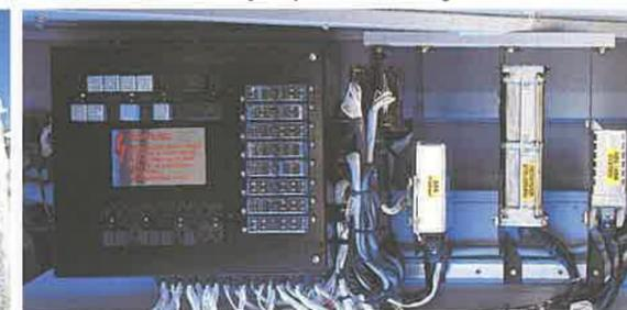
*Alta tecnologia: facilita molte operazioni, ne rende possibili molte altre. Un esempio è la semplificazione del cablaggio. Tecnologia per la sicurezza. In officina basta premere un pulsante per ottenere verbali per assistenza e manutenzione. Con un Setra tutto questo è possibile.*
