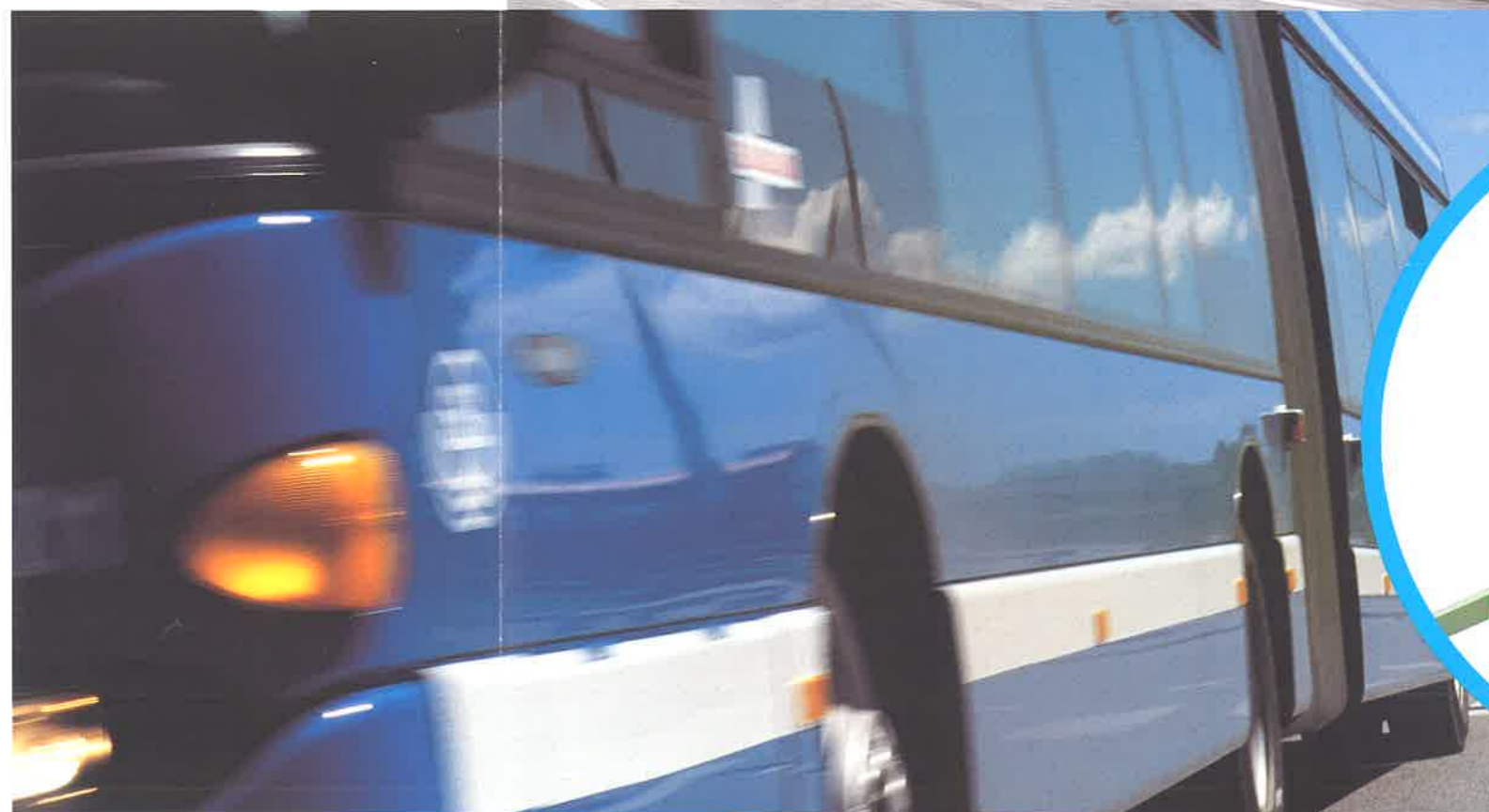
La versione snodata di OmniCity Scania è lunga 18 metri ed è disponibile in varie versioni in funzione del numero e del tipo di porte installate.
