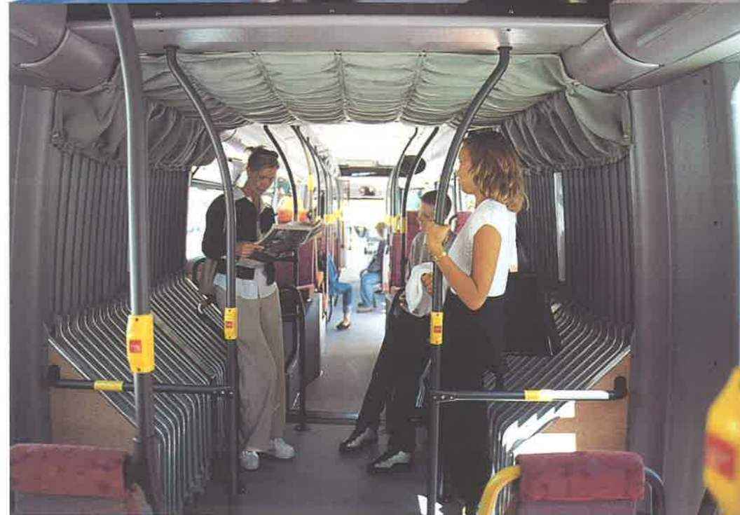
La versione snodata di OmniCity Scania è lunga 18 metri ed è disponibile in varie versioni in funzione del numero e del tipo di porte installate.
