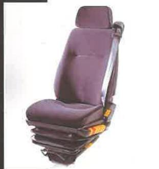
Nouveau siège conducteur suspendu pneumatique, avec tête et ceinture de sécurité 3 points à enrouleur.
