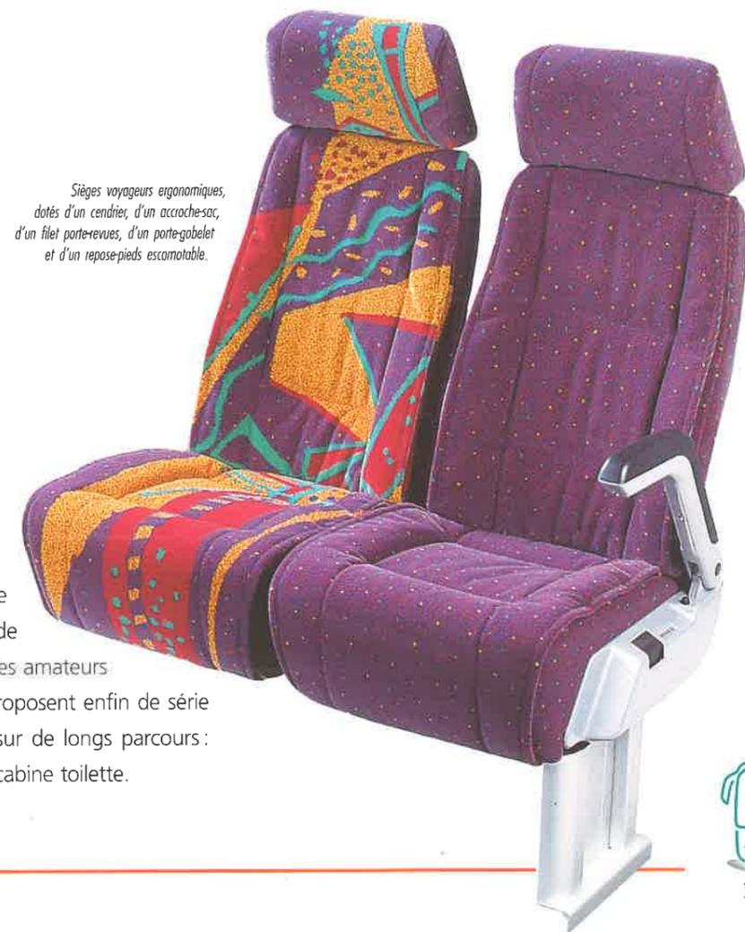
Sièges voyageurs ergonomiques, dotés d'un cendrier, d'un accroche-sac, d'un filet porte-revues, d'un porte-gobelet et d'un repose-pieds escamotable.
