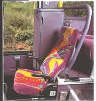
Nouveau siège guide, doté d'une ceinture de sécurité 3 points à enrouleur.
