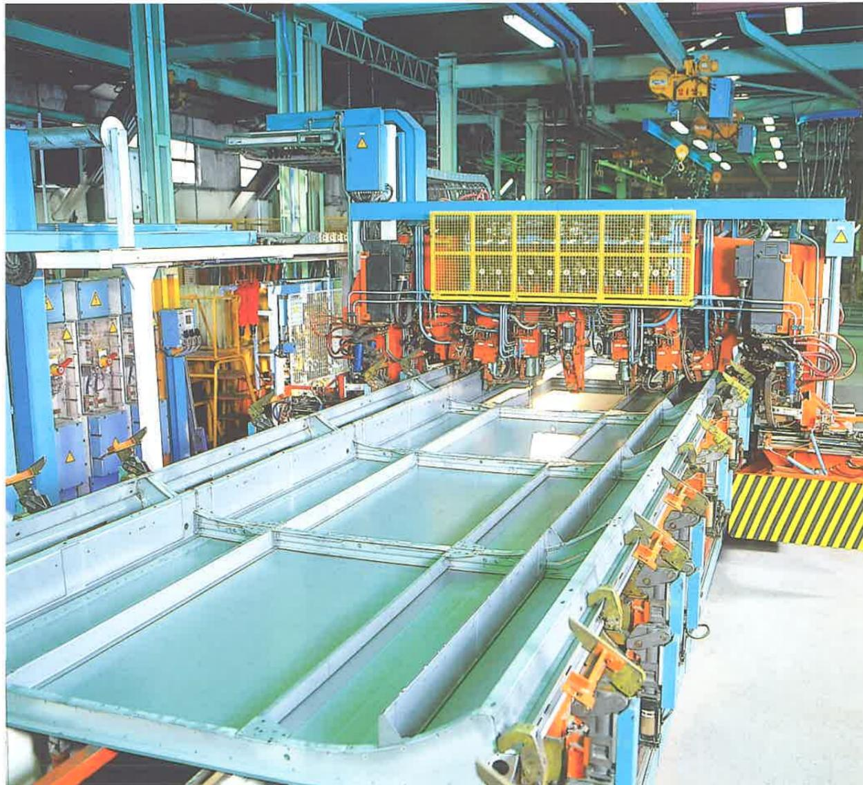
Saldatura della struttura del padiglione
