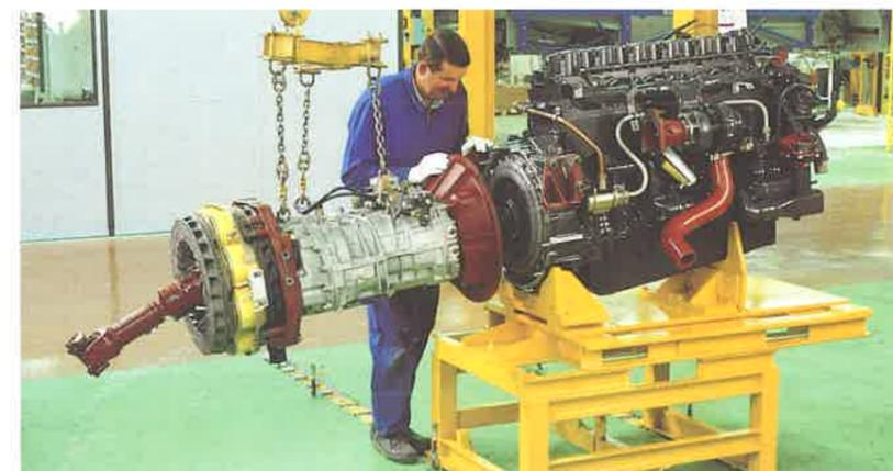
Assemblaggio del motore
