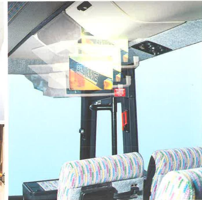
Televisore a colori da 15" a schermo piatto e videoregistratore alloggiati in cassetto a cerniere chiuse. Il movimento di uscita a scorrimento in avanti, aumenta il campo visivo dei passeggeri. Possibile l'installazione di un monitor pure a scomparsa in posizione centrale.
