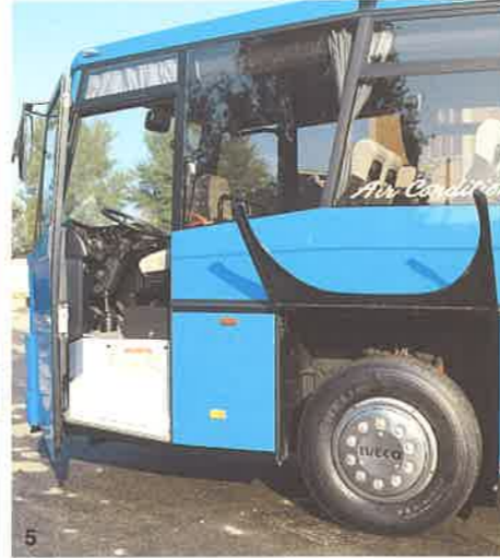
5) Porta autista con alzacristallo elettrico e sbrinatorio termico. Comoda accessibilità ai vani ruote, alla centralina dell'impianto elettrico ed al vano portapacchi con chiusura di sicurezza.
