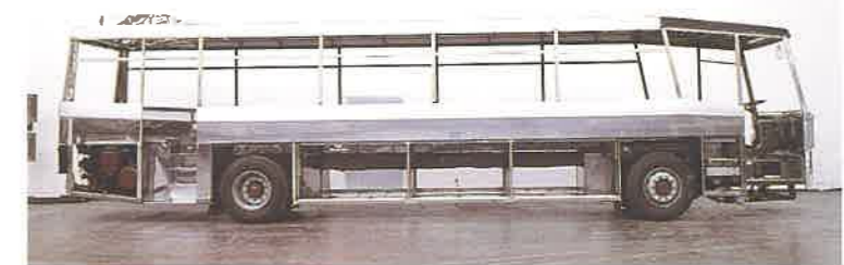
8) Scocca "a prova di corrosione" interamente in acciaio INOX AISI 304. Rivestimenti interni ed esterni in materiali inossidabili, quali acciaio inox, alluminio, vetroresina ed altri materiali plastici.
