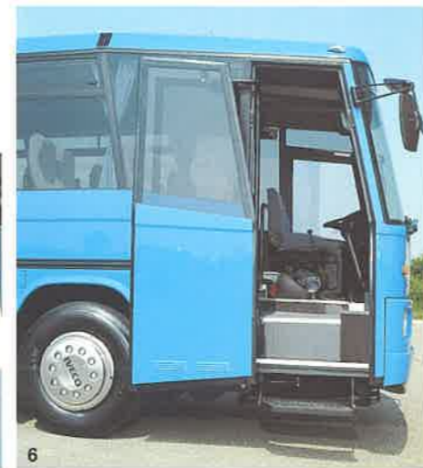
6) Porte salita passeggeri a movimento pneumatico rototraslante complete di dispositivi di emergenza a protezione dei passeggeri. Salita anteriore con pedana mobile sincronizzata. Gradini di salita rivestiti in materiale antisdrucciolo.
