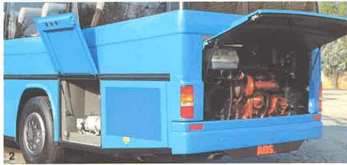
2) Il vano motore e quello preriscaldatore sono comodamente accessibili grazie ad ampi sportelli che favoriscono una facile manutenibilità.
