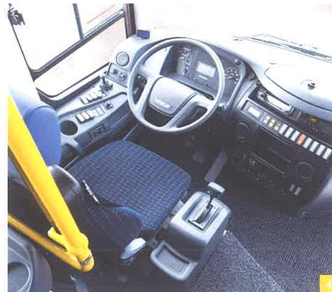
Navigo U dispone di un posto di guida ergonomico e spazioso. Il cambio manuale Eaton ESO 6206 può essere sostituito (in opzione) da un cambio automatico, per una guida agile e confortevole. L'EBS l'ESP e a richiesta LDWS e l'AEBS, garantiscono la sicurezza, per passeggeri e conducente.
