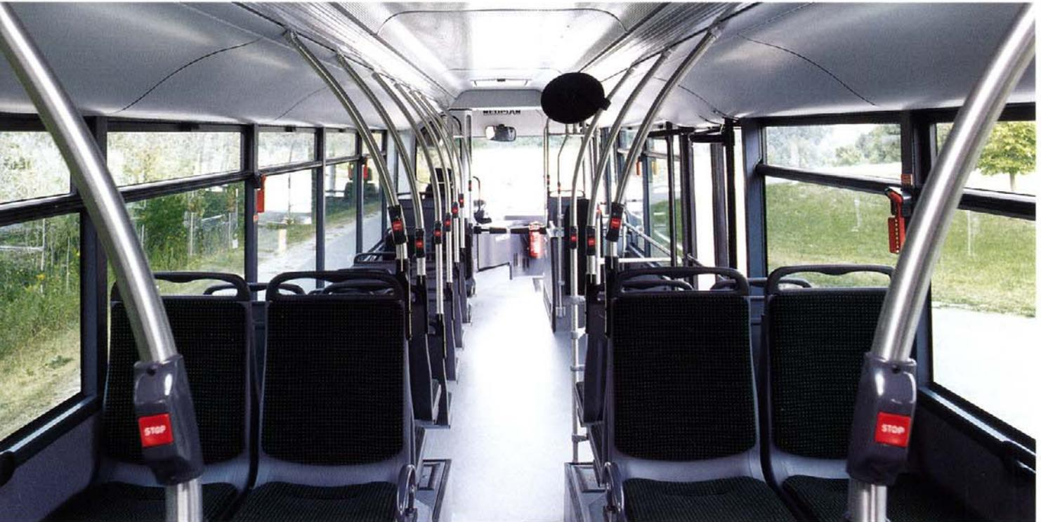
der Sitze nicht nur hochmodern, sondern auch äußerst reinigungsfreundlich. Klar: Am Boden des Busses sind keinerlei Leisten oder Verschraubungen angebracht. Ein weiterer Pluspunkt für den Centroliner: Dank der fehlenden Podeste im Mittelgang bietet der Bus den Fahrgästen
