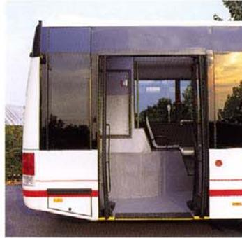
*Towerbauweise: Weil der Motor stehend eingebaut wird, ist der Fahrgastraum stufenlos und podestfrei an allen Türen – 100 % Niederflur.*
