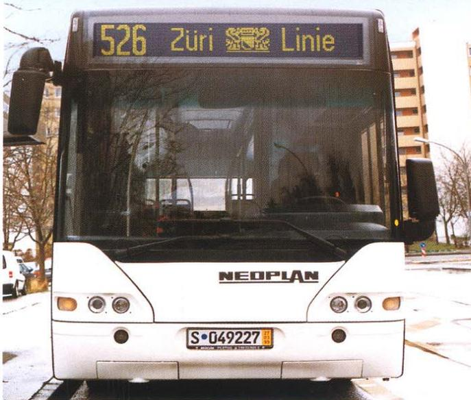
**Mobile Fahrgast- Informationssysteme leiten, informieren und organisieren, damit sich die Fahrgäste in dichten Verkehrsnetzen besser zurechtfinden.** Früher kurbelte der Busfahrer die Rollbänder vor und zurück. Heute stehen automatisch gesteuerte Matrix-Anlagen in Flip-Dot-Technik bis hin zu LCD-Informationsanzeigen im Mittelpunkt. Die Inhalte werden schnell und einfach erstellt oder geändert und über eine zentrale Ladebuchse oder per Chipkarte übertragen. Die Oberfläche der Matrix-
