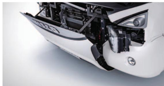
La calandra si ribalta in avanti per consentire l'accesso all'unità di climatizzazione del conducente e al serbatoio del liquido lavavetri. Il blocco fari ruota per un accesso diretto al cablaggio ed alle lampadine.
