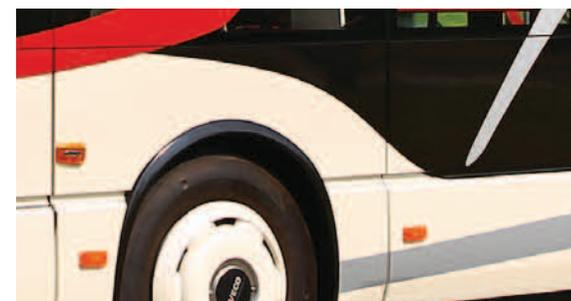
Ogni pannello della carrozzeria è avvitato per sostituzioni semplici e veloci.
