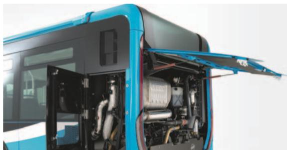
Il vano motore è facilmente accessibile tramite pannelli ad apertura rapida.
