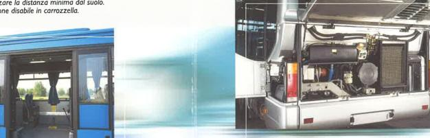
Accessibilità al vano motore
