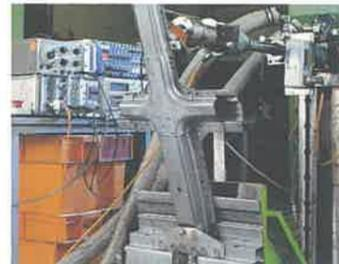
Tests vibratorio del montante della porta.
