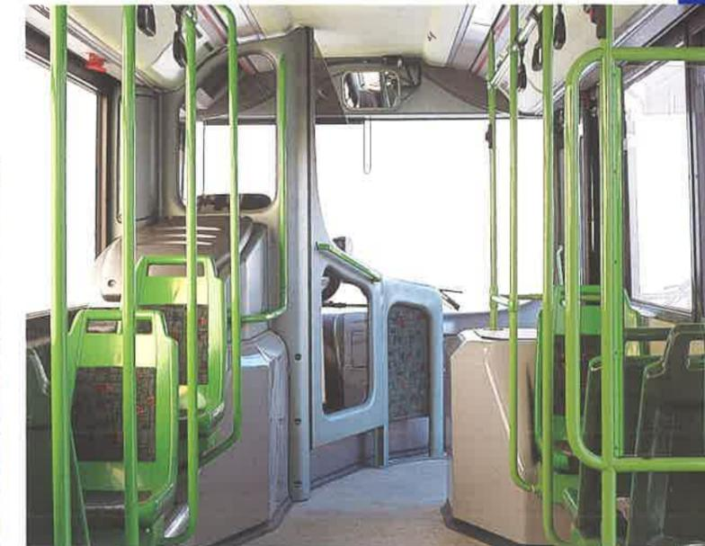
*I robusti sedili passeggeri monoscocca dal disegno avvolgente, sospesi a sbalzo e realizzati in resina plastica, facilitano le operazioni di pulizia.*
