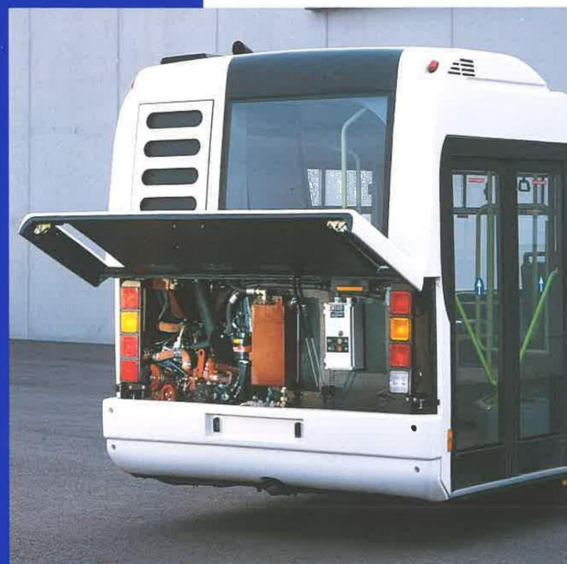
*I numerosi accessi alle parti meccaniche, tutti con sportelli in lega leggera, riducono ai minimi termini i tempi della manutenzione ordinaria. La centralina elettrica è posta all'interno, alle spalle del posto guida.*
