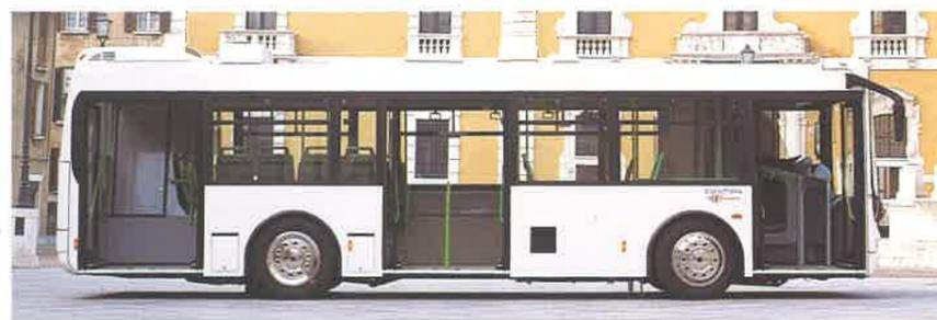
*La concezione modulare di EuroPolis, realizzato con struttura autoportante in acciaio (a richiesta in acciaio inox), permette una totale versatilità negli allestimenti e nelle versioni.*
