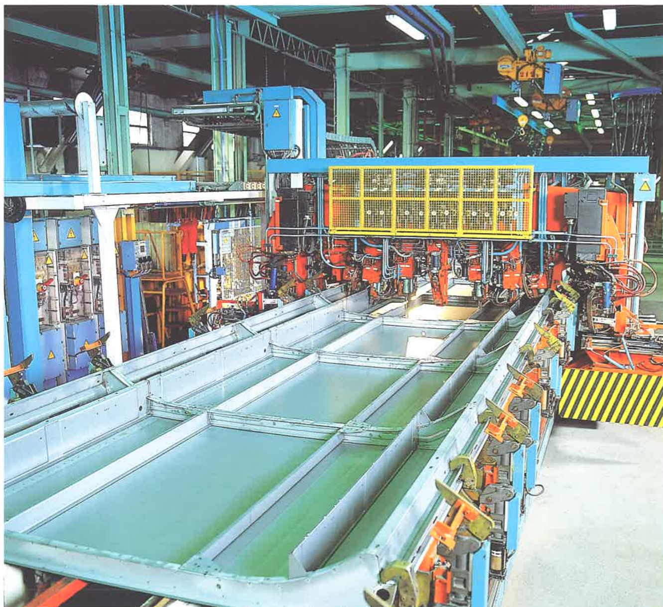
Saldatura della struttura del padiglione
