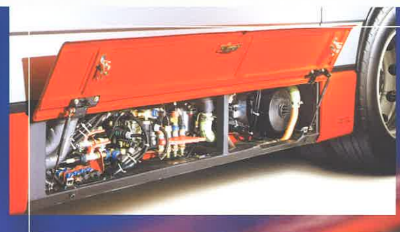
Sistema centralizzato per lo scarico condensa dell'impianto pneumatico.
