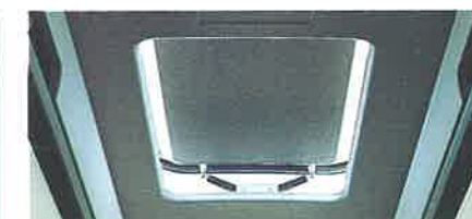
Botole padiglione a comando elettrico con funzione uscite di emergenza.
