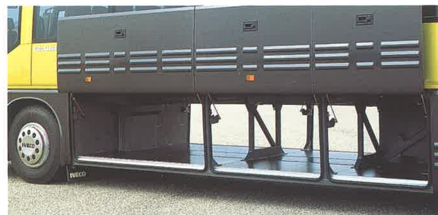
Capace bagagliaia con sportelli a pantografo a chiusura centralizzata e assenza di ingombri.
