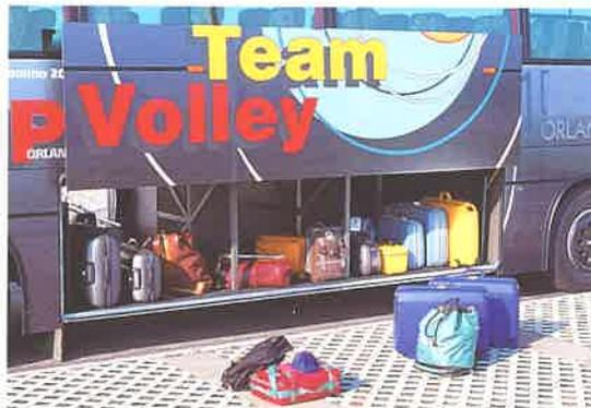
*L'ampia bagliera passante insieme alle cappelliere interne permette il trasporto di oltre 12 m<sup>3</sup> di bagaglio. Il portellone bagliere sul lato sinistro è unico ad azionamento pneumatico con comando da posto guida.*
