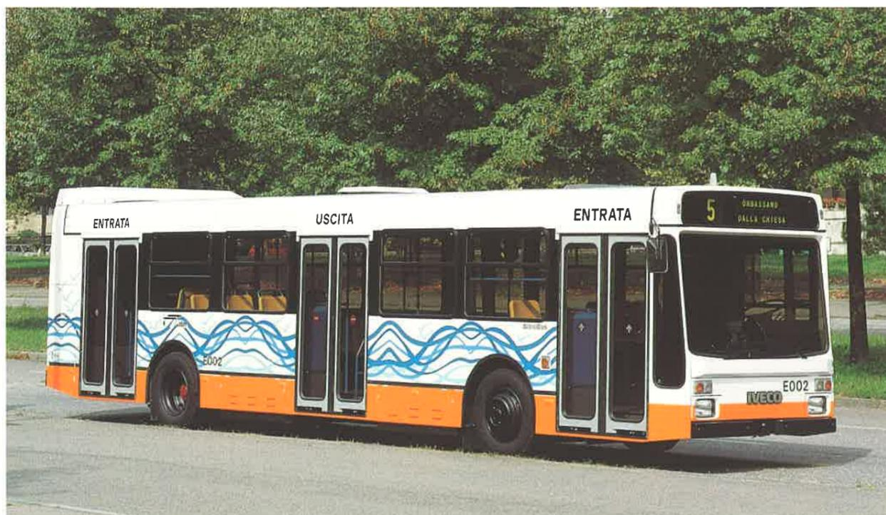
Silenzioso ed ecologico, l'autobus "ibrido" Iveco unisce ai vantaggi della trazione elettrica una autonomia analoga a quella consentita ai veicoli tradizionali, con motorizzazione Diesel.
