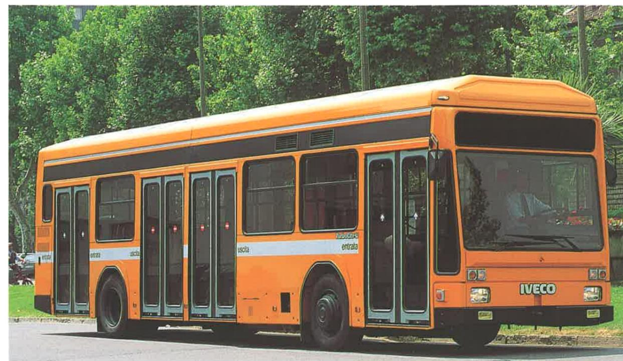
Emissioni acustiche e gassose estremamente contenute ed economicità di acquisto ed esercizio per un autobus che utilizza un combustibile alternativo a basso costo. È quanto Iveco offre con le versioni alimentate a gas metano dei suoi autobus urbani e suburbani 490E e 590E da 10 e 12 metri. Veicoli già oggi in regola con le future normative, oltre la Euro 2, anticipando la ancora maggiore severità dell'Euro 3.
