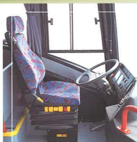
*Postazione di guida funzionale con sedile a sospensione pneumatica completamente regolabile in altezza, inclinazione e posizione longitudinale, in tessuto coordinato con gli interni.*
