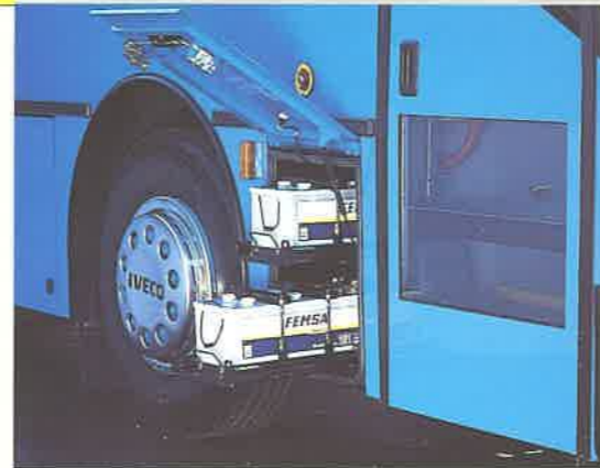
Impianto elettrico: 2 batterie da 12V, 180 Ah senza manutenzione, montate su cestello a scorrimento. Alternatore da 28 V - 120 A. Motorino d'avviamento da 5,4 kW.
