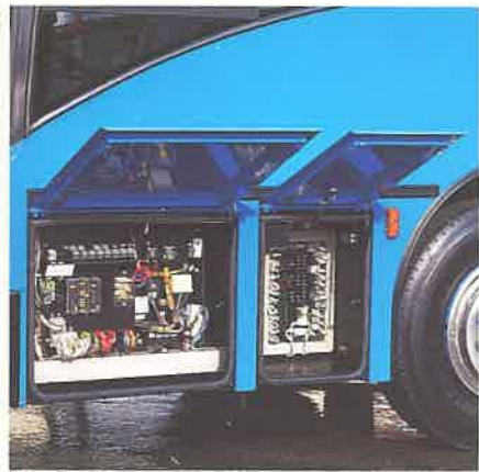
Impianto elettrico: 2 batterie da 12V, 180 Ah senza manutenzione, montate su cestello a scorrimento. Alternatore da 28 V - 120 A. Motorino d'avviamento da 5,4 kW.
