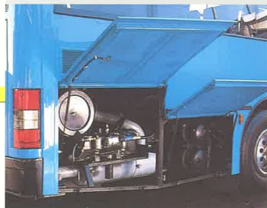
Sportelli d'accesso: agli organi meccanici e agli impianti con apertura a compasso, al vano motore a pantografo, semplificano e accelerano le operazioni di manutenzione.
