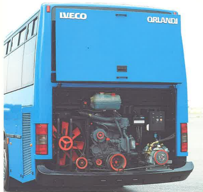
Sportelli d'accesso: agli organi meccanici e agli impianti con apertura a compasso, al vano motore a pantografo, semplificano e accelerano le operazioni di manutenzione.
