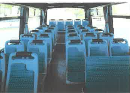
Sedile mod. CA 2015. Scuole Medie, antivandalo in monoscocca con schienale e plancia completi di imbottitura in tessuto.
