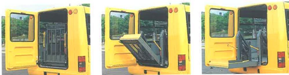
Sollevatore elettroidraulico a due bracci, completamente automatico, azionato da comando a cavo o da pulsantiera supplementare fissata sullo stesso.
