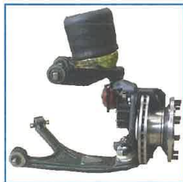
Sospensione anteriore a ruote indipendenti: stabilità, comfort e sicurezza.
