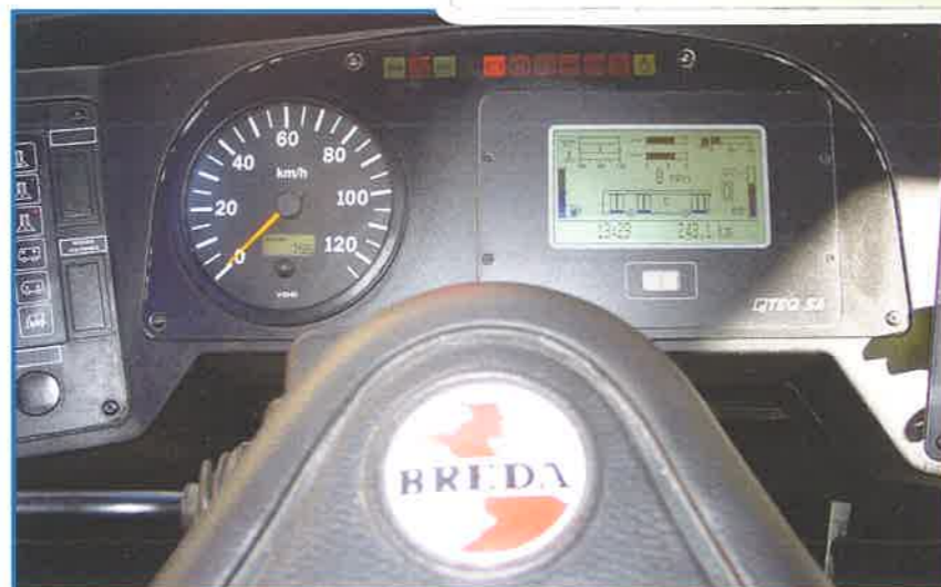
Impianto Multiplex con funzioni di diagnostica on board e off board (GSM).
