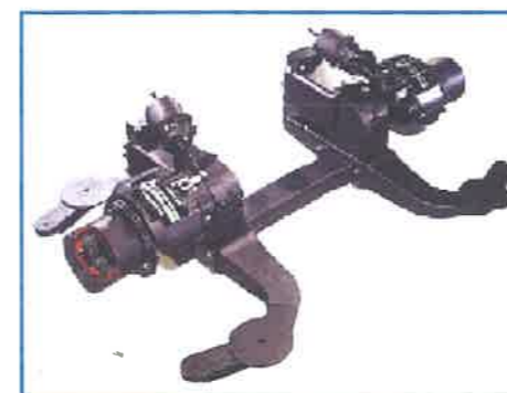
Motori elettrici al ponte. Trazione elettrica con funzione di differenziale elettronico
