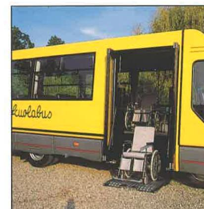
*Elevatore automatico carrozzelle*
