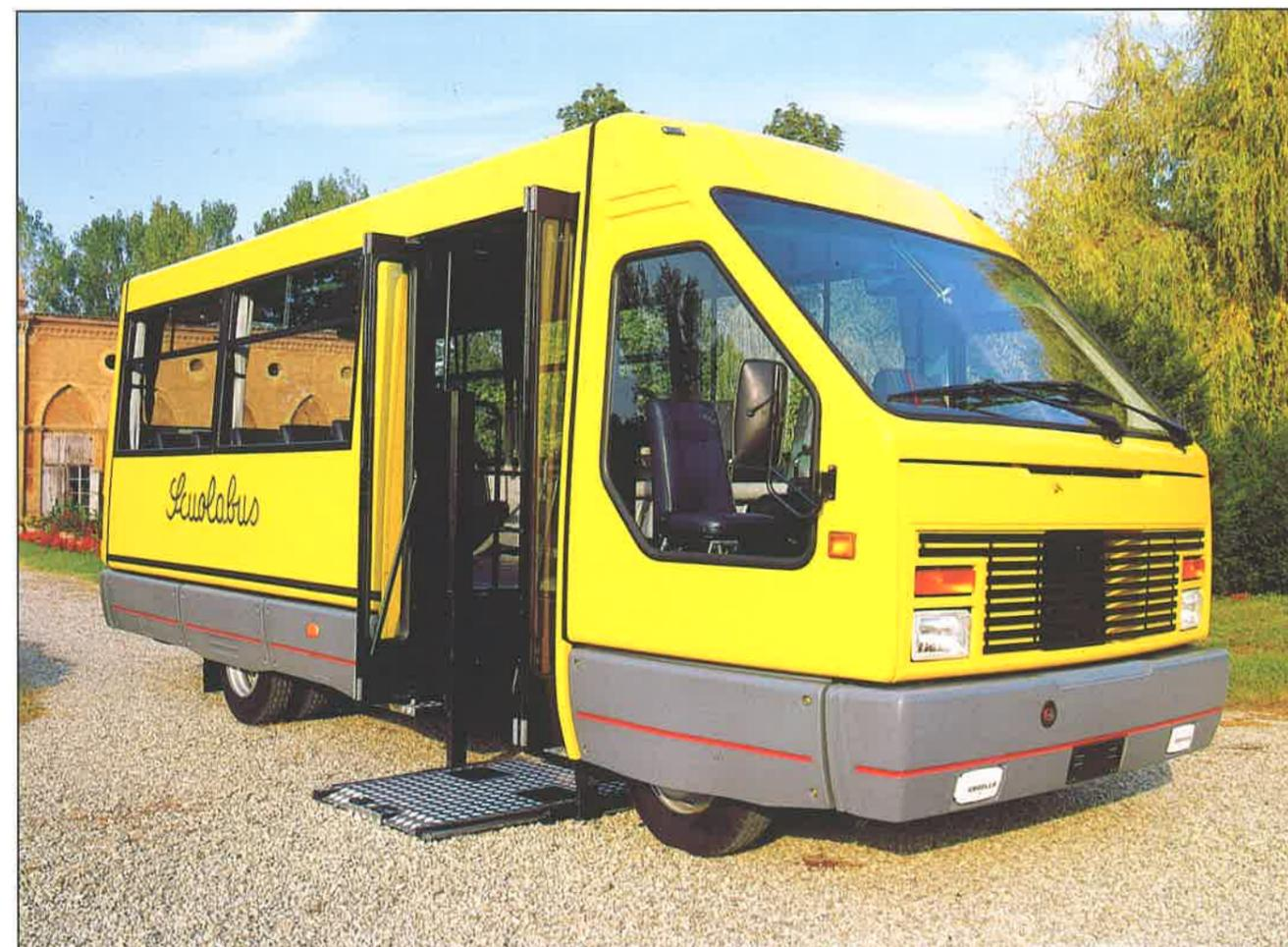
*Scuolabus attrezzato per alunni con ridotta capacità motoria (A.70)*
