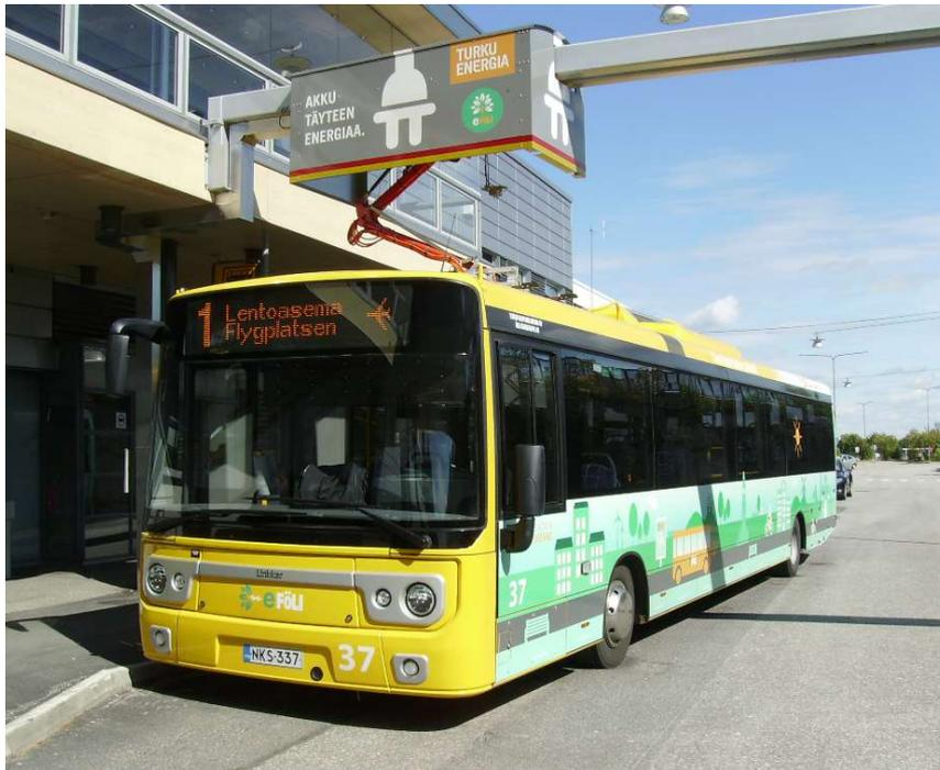
*Foto 59 - Turku: bus elettrico Linkker sotto carica durante la sosta al capolinea dell' aeroporto*
