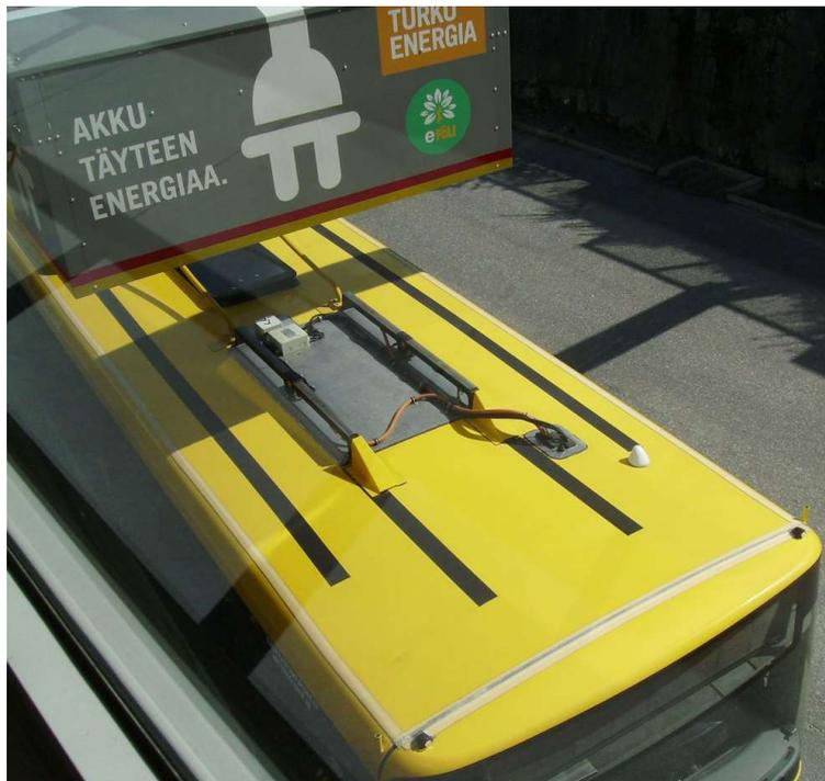
*Foto 60 - Turku, bus elettrico Linkker: particolare dei due contatti sul tetto del mezzo ( ai due lati del rettangolo grigio )*
