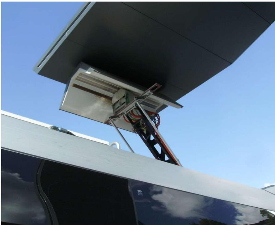
*Foto 70 - Particolare del pantografo dell' Urbino Electric durante la carica da portale*
