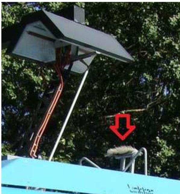
*Foto 90 - Particolare, indicato dalla freccia rossa, della “scopa” sul tetto di un Linkker di Transdev*
