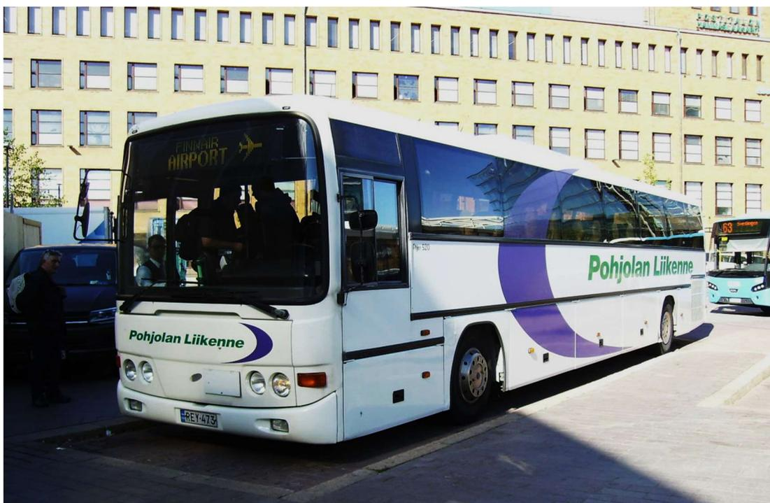
*Foto 101 - Nel giorno dello sciopero dei treni, inconsueta presenza di questo Lahti Flyer 520, interurbano di linea su telaio Scania K94, sul servizio Helsinki-Vantaa aeroporto per conto di Finnair, normalmente effettuato con soli mezzi GT*
