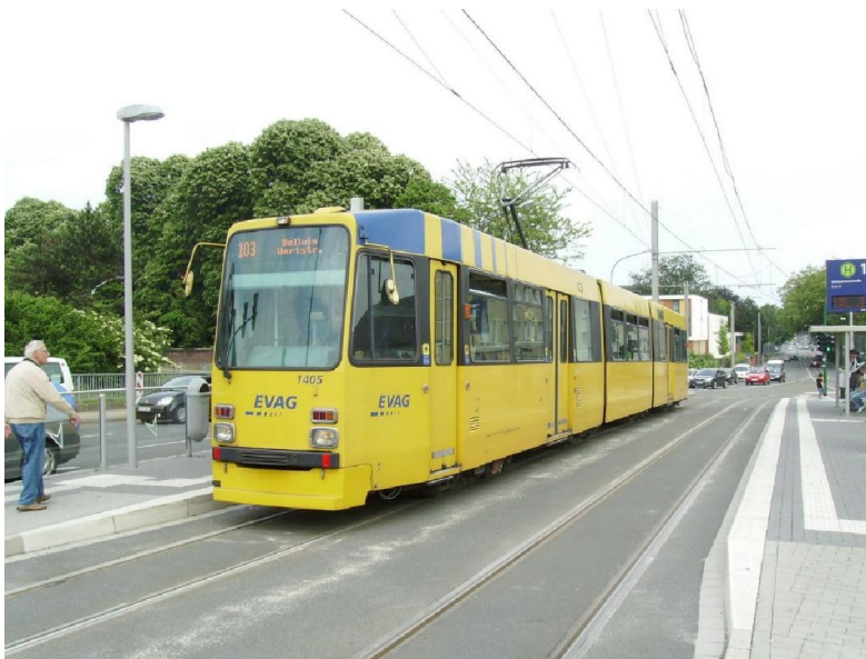
Foto 20 - Essen: tram 1405, Duewag M8DNF, sostanzialmente analogo al precedente ma a pavimento ribassato, ripreso sulla stessa linea ed alla medesima fermata
