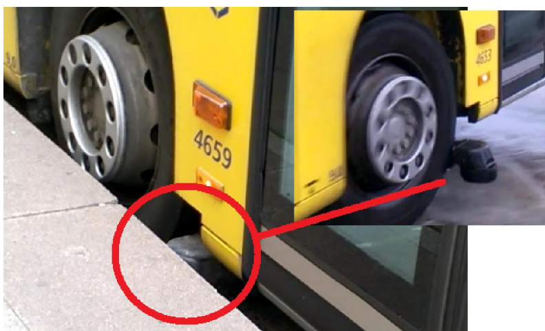
Foto 16 - Le ruotine su cui si basa il sistema O-bahn di Mercedes adottato ad Essen
