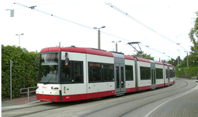
Foto 22 - Dortmund: tram 40, uno dei Bombardier Flexity Classic NGT8 a piano ribassato sulla linea U43, in uscita dal deposito Dorstfeld nel quale fa capolinea
