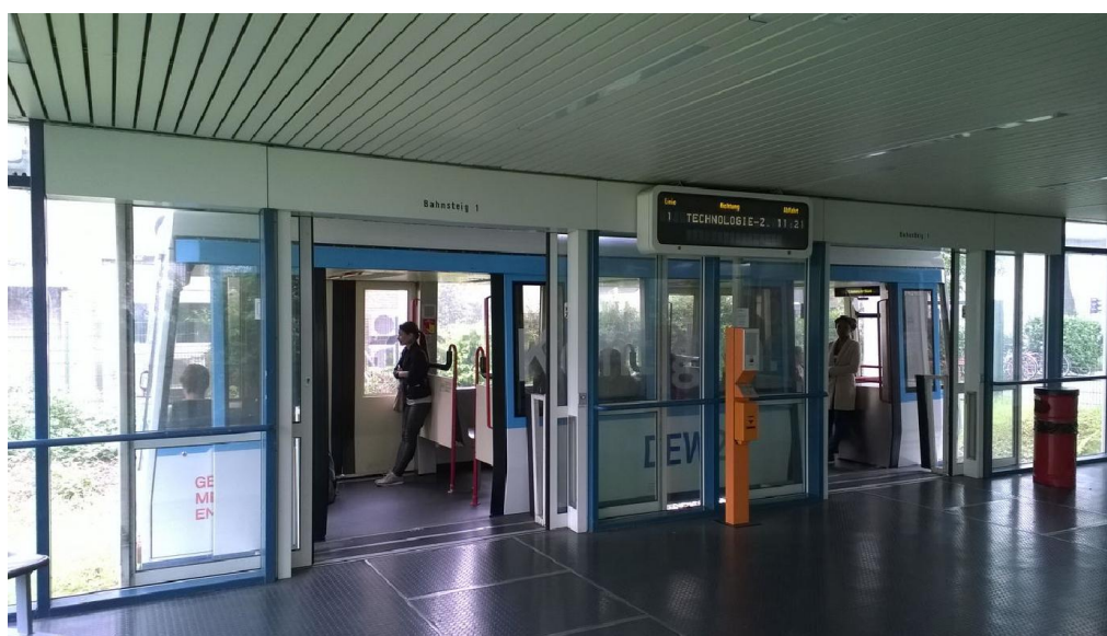
Foto 28 - Dortmund: un veicolo pronto alla partenza da Eichlinghofen; notare la continuità del pavimento tra stazione e veicolo
