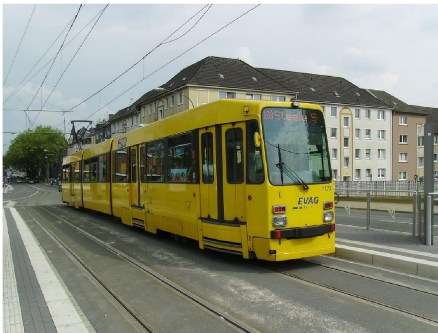
Foto 19 - Essen: tram 1173, Duewag M8C a pavimento alto per esercizio su linee tipo Stadtbahn, in servizio sulla linea 103 alla fermata tra Steeler str. e Schwanenbuschstr.
