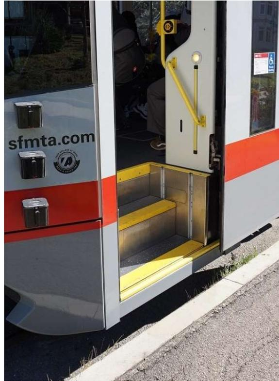
*Foto 6 - Particolare dei gradini mobili di un tram Siemens su una porta d' estremità*
