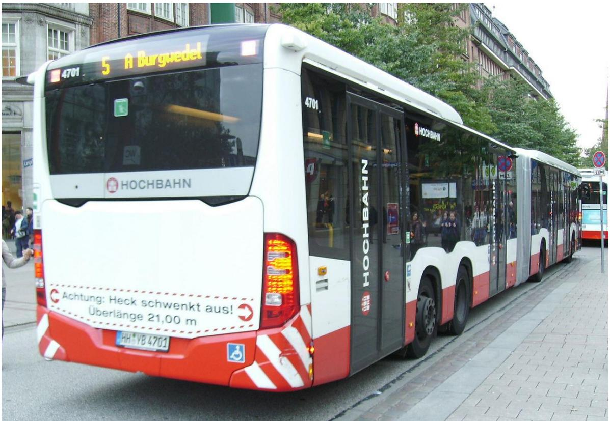
Foto 7 - Posteriore del Mercedes Capacity, con i due assi ravvicinati di cui l'ultimo sterzante, come ricorda il messaggio d'attenzione subito sopra al paraurti, che indica anche il fuori misura di 21m
