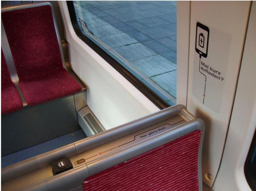
*Foto 4 - Interno di un treno serie DT5: particolare di una delle prese USB per la ricarica di dispositivi portatili*
