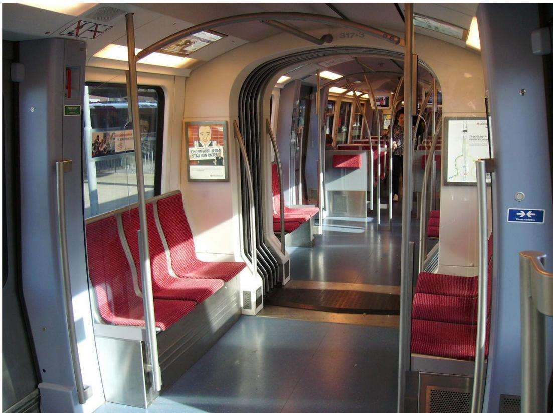
Foto 3 - Interno di un treno serie DT5: particolare dell' intercomunicante tra due casse
