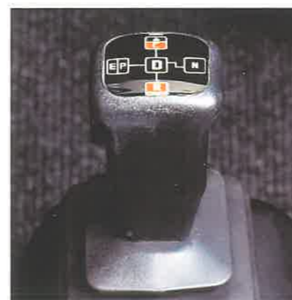
Lavier de commande TBV solidaire du siège conducteur
