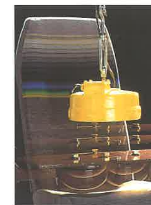
Tests de résistance des sièges.
