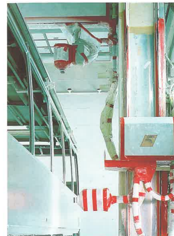
Dépôt de peinture par "minibols électrostatiques".
