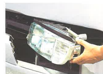
Pivotement du bloc optique pour le remplacement de l'ampoule.
