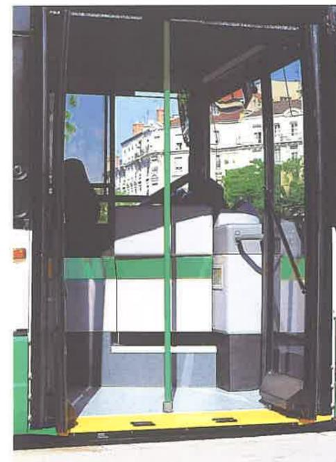
"L'inginocchiamento" del veicolo, alle fermate, permette di ridurre ulteriormente l'altezza tra il pianale e il marciapiede, per un accesso praticamente in piano.
