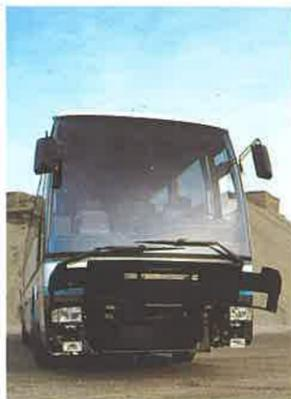
Per ogni tipo di intervento, uno sportello a pantografo garantisce la più completa accessibilità al vano motore.
