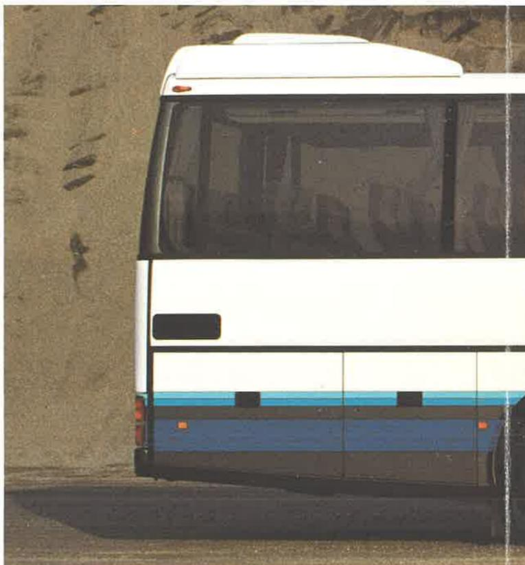
I pannelli delle fiancate sono modulari, in lega leggera sagomata, stratificati per facilitare le operazioni di incollaggio e di sostituzione in caso d'urto. Per accrescere la rigidità e l'isolamento termico ogni pannello è realizzato a doppio guscio con poliuretano iniettato. I rivestimenti sono interamente in lega anticorrosione e in resina rinforzata. Le saldature riguardano unicamente l'assemblaggio dei grandi gruppi e l'unione degli stessi al telaio.
