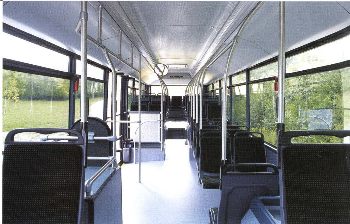
Praktisch: die Cantilever-Aufhängung der Sitze, an Seitenwandschienen angebracht.
