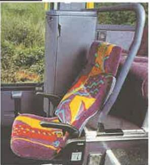
Sedile er la guida con cintura di sicurezza a 3 punti e riavvolgitore.
