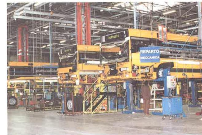
produzione, i gruppi meccanici formati da motopropulsore, ponte e assale, precedentemente composti in sottogruppi, sono assemblati al veicolo, al termine della sellatura.
