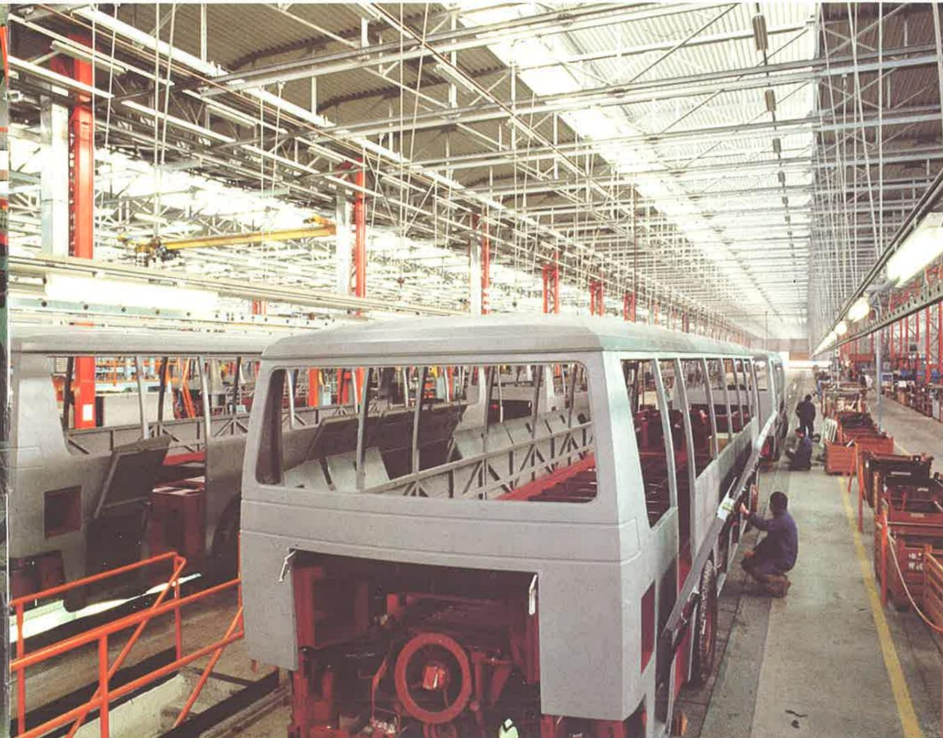
Una linea di ferrostruttura articolata in 15 stazioni per la progressiva saldatura dei componenti
