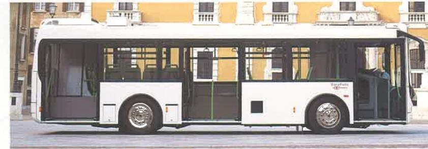
*La concezione modulare di EuroPolis, realizzato con struttura autoportante in acciaio Corten autopassivante, permette una totale versatilità negli allestimenti e nelle versioni.*
