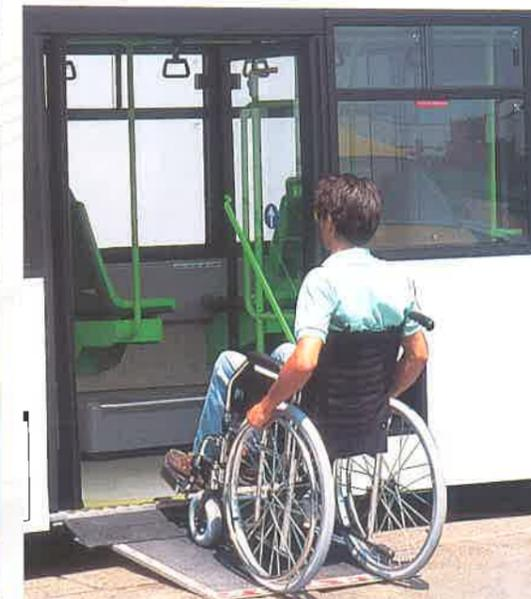
*La porta centrale può essere dotata di scivolo mentre l'area attrezzata, con sistema di bloccaggio pneumatico per le carrozzine, trova posto sul lato sinistro.*
