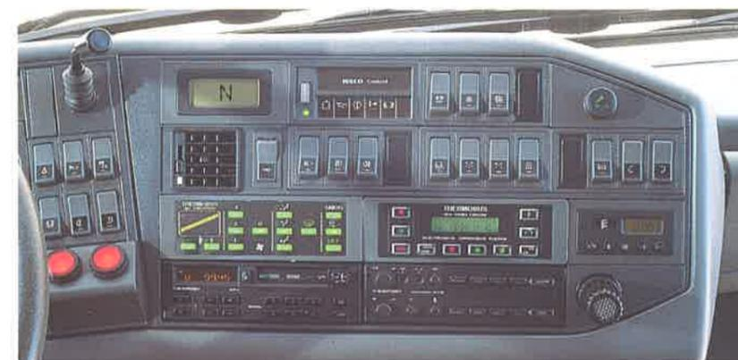
Particolare comandi sul cruscotto comprendenti tra l'altro la centralina di regolazione della climatizzazione, l'autoradio con riproduttore stereo, il check-control che segnala eventuali anomalie agli impianti del veicolo.
