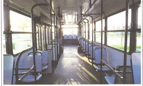
Mancorrenti realizzati con tubi di acciaio rilsanizzati di colore nero opaco.
