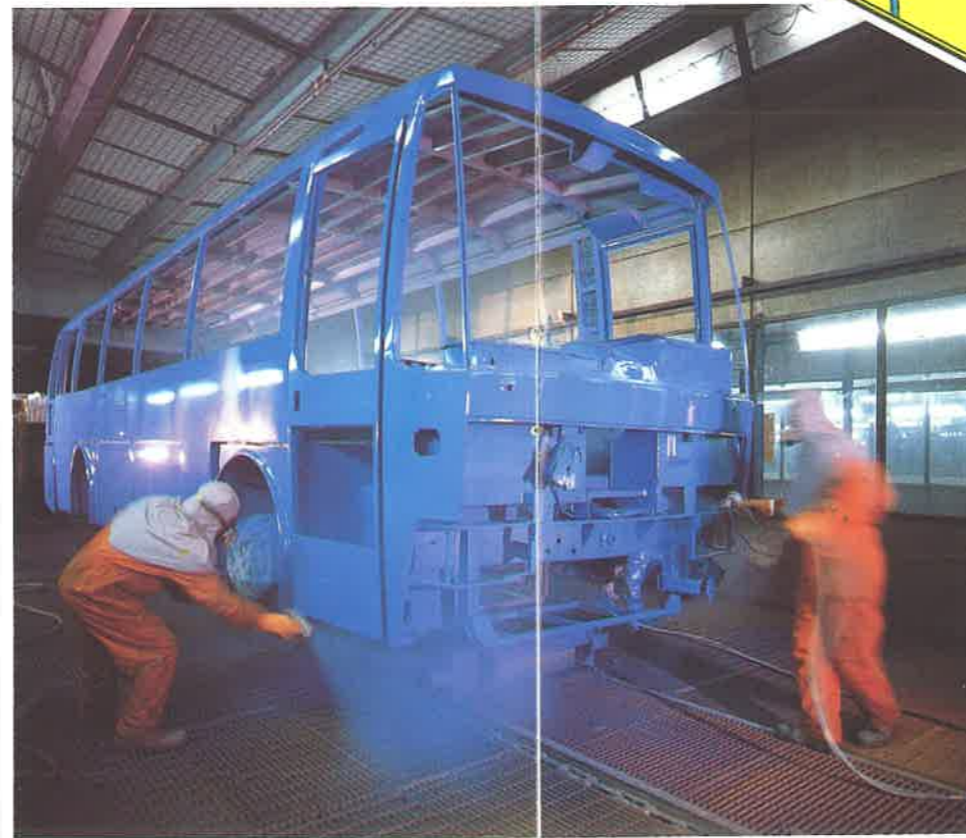
Una fase del ciclo di verniciatura.
