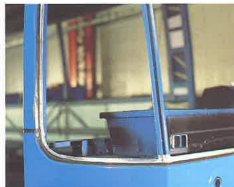
Protezione dei vani per cristalli e finestrini. Immersione del telaio per trattamento elettroforetico.
