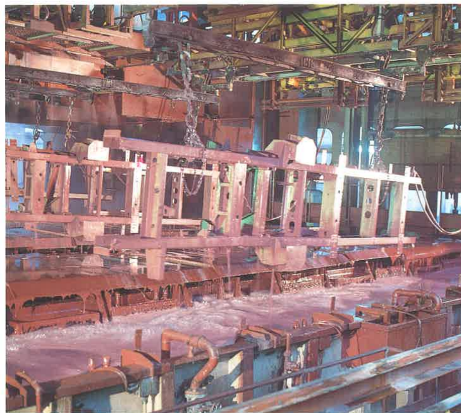
Protezione dei vani per cristalli e finestrini. Immersione del telaio per trattamento elettroforetico.
