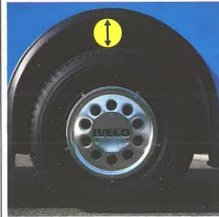
Per muoversi su terreni difficili o accidentati è possibile sollevare, per brevi tratti e a velocità ridotta, il veicolo di alcuni centimetri.
