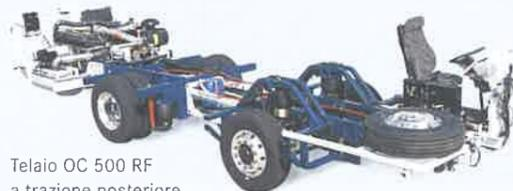
Telaio OC 500 RF a trazione posteriore
