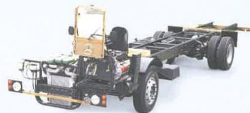
Telaio OF a trazione anteriore
