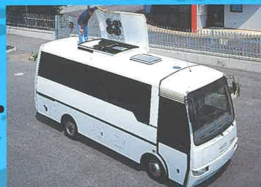
Manutenzione impianto aria condizionata
