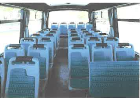
Sedile mod. CA 2015. Scuole Medie, antivandalato in monoscocca con schienale e plancia completi di imbottitura in tessuto.
