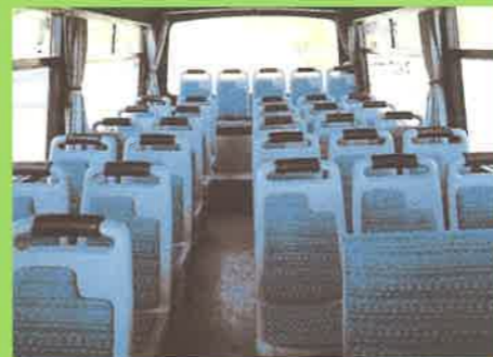
• Sedile mod. CA 2015. Scuole medie, antivandalo in monoscocca con schienale e plancia completi di imbottitura in tessuto.
