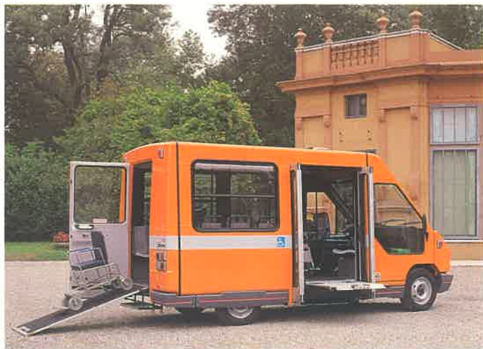
Scivolo manuale posteriore con porta di sicurezza
