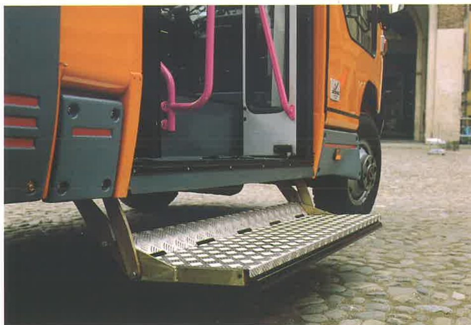
Particolare pedana mobile per abbassamento livello di salita
