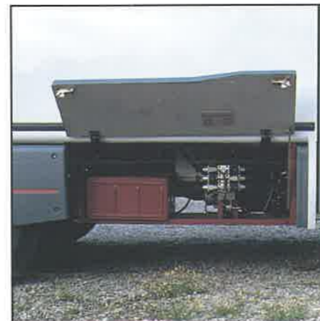
Meccanismi apertura porta laterale e sollevamento elevatore
