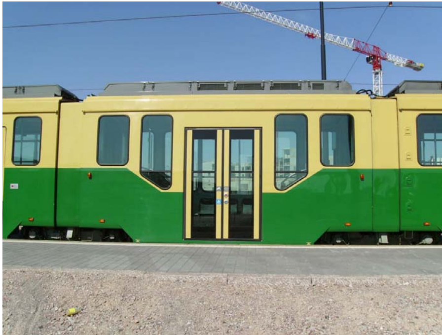
Foto 4 - Particolare della cassa centrale ribassata aggiunta al tram 88
